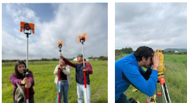
Figura 6. Identificamos el proceso de recolección de datos con el apoyo de la estación total (Fuente: autoría propia).
