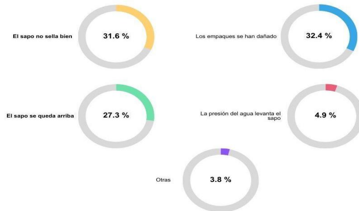
Figura 6. Causas principales de las fugas de agua en los sanitarios.
