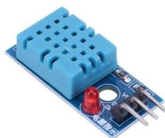
Figura 2. Sensor DHT11 utilizado en el sistema de monitoreo. Fotografía original del autor (2025), basada en la descripción técnica de Gay (2018) y Aosong Electronics Co., Ltd. (2023).
