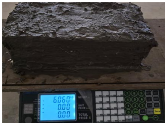
Figura 4 Registro dimensional y de masa en húmedo Peso y medición (largo × ancho × alto) con el calibrador (Fuente propia 2025)
