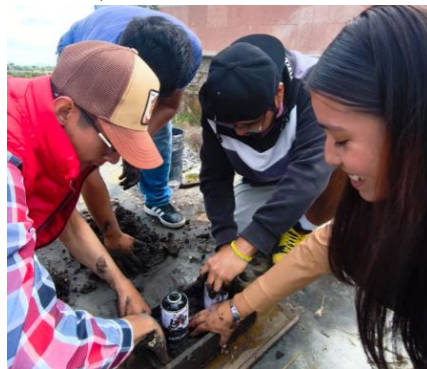
Figura 3 Relleno del molde en capas de aproximadamente 2 cm de espesor hasta alcanzar el borde superior del molde (Fuente propia 2025)
