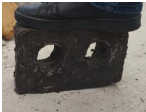
Figura 6 Reposo inicial los moldes llenos se mantuvieron en reposo durante 24 h en sitio cubierto y ventilado (Fuente propia 2025)
