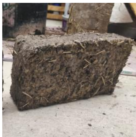
Figura 7 Secado natural (solar) Los bloques desmoldados se colocaron y expuestos al secado solar controlado( Fuente propia 2025)
