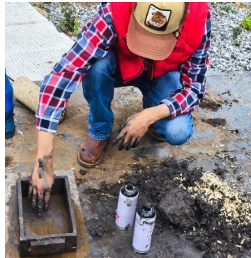
Figura 2 Preparación del molde de 15x27x8cm previamente mojado (Fuente propia 2025)
