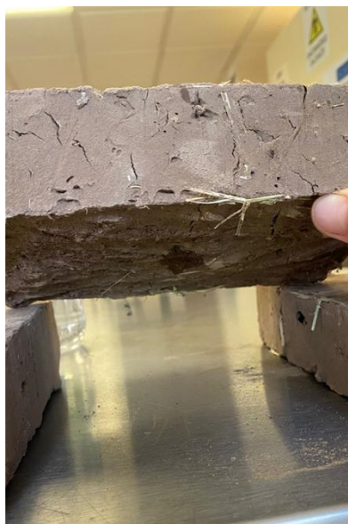
Imagen 10. Se observa la filtración de agua en la probeta de adobe (Fuente: autoría propia).
