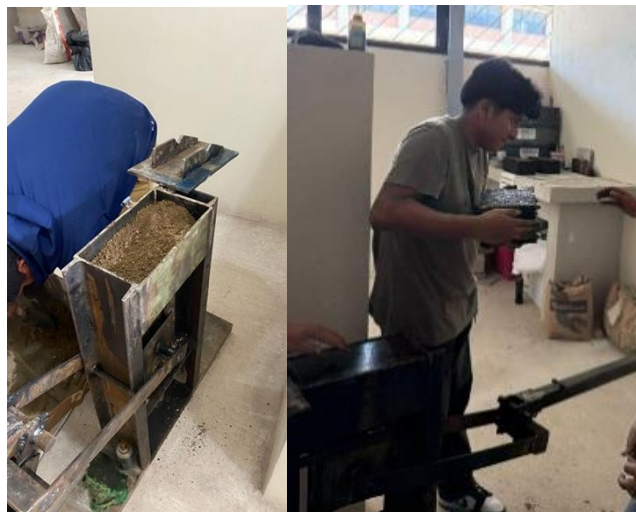
Imagen 3. Fabricación de probetas de adobe (Fuente: autoría propia)
