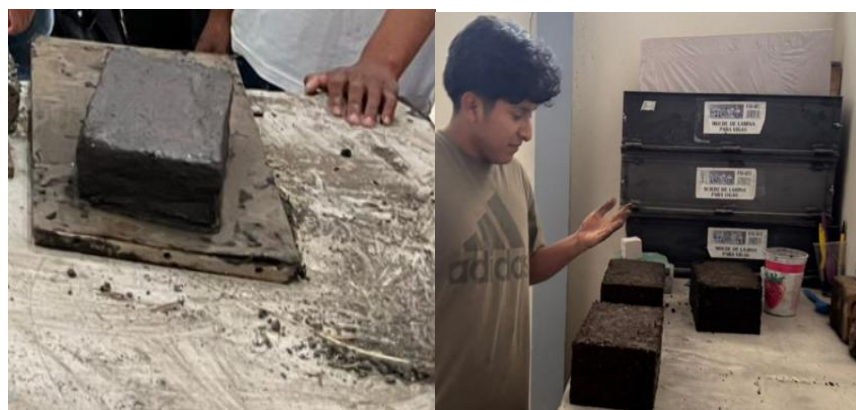
Imagen 4. Se aplicó compactación uniforme mediante golpeado manual para la fabricación de probetas (Fuente: Autoría propia).
