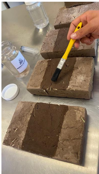
Imagen 9. Aplicación del mucílago en las probetas de adobe (Fuente: autoría propia).
