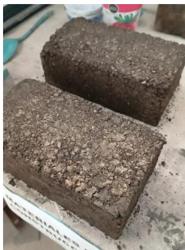
Imagen 5. Secado de las probetas de adobe a la sombra durante 6 días (Fuente: autoría propia).
