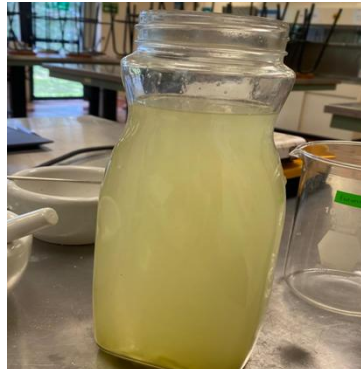
Imagen 8. El mucílago viscoso se separó de residuos sólidos mediante malla fina, obteniendo solución acuosa lista para aplicación (Fuente: autoría propia).
