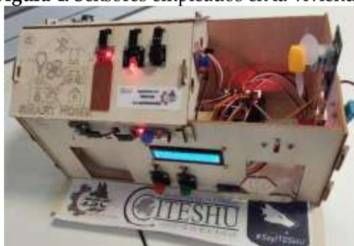
**Figura 5.** Sensores implementados en la vivienda.
