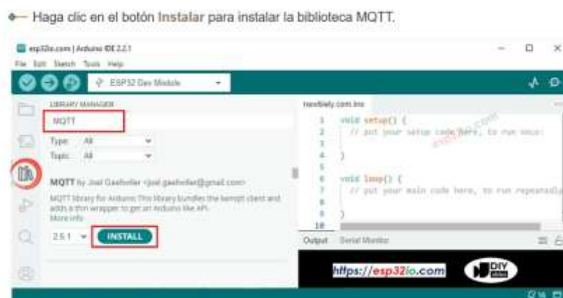
Figura 4. Instalación de biblioteca MQTT.
