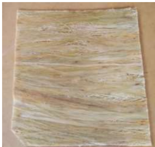
Figura 3 Biocompuesto de resina epóxica reforzada con fibras de agave
