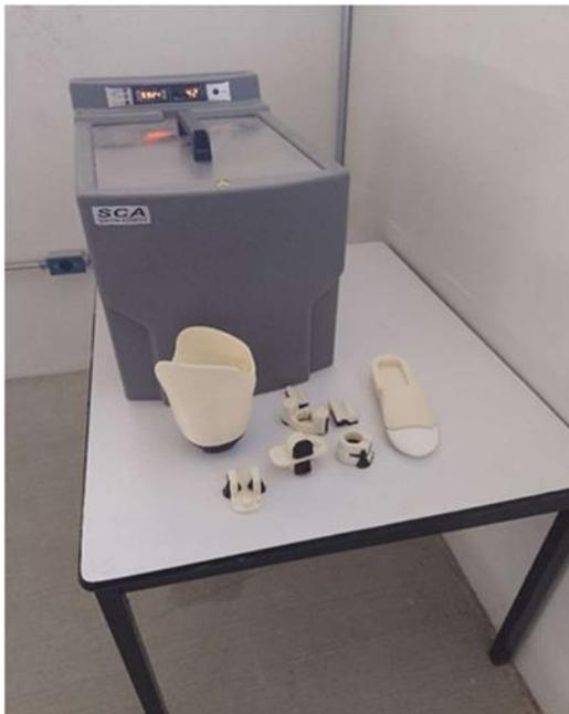
**Figura 5 Piezas de la prótesis impresa**
