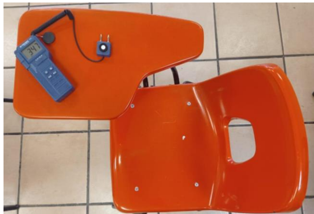
Figura 4. Medición de nivel de iluminación en butaca del aula E5
