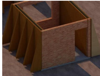
Figura 6. Despiece de cimbra en el modelo del prototipo (isométricos) (Fuente: autoría propia).
