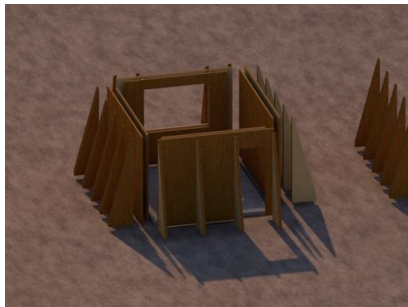
Figura 4. Despiece de cimbra en el modelo del prototipo (Fuente: autoría propia).
