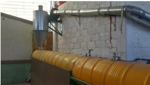
*Fotografía 1 Sistema hecho de la secadora de aserrín actual.*
