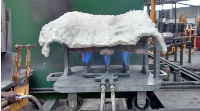
Figura 6 Calentamiento de molde con la mesa giratoria en la línea de carrusel 1.
