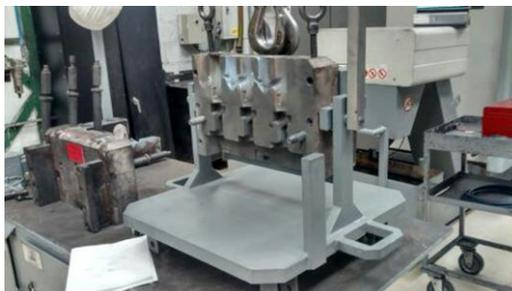
Figura 5. Diseño del prototipo montado en la mesa giratoria en la línea de producción.
